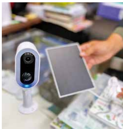
太陽光発電が電源となっている 防犯カメラ・センサー
